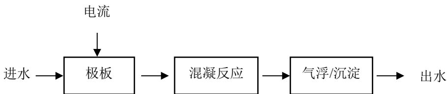
图 3 电混凝工艺流程图
