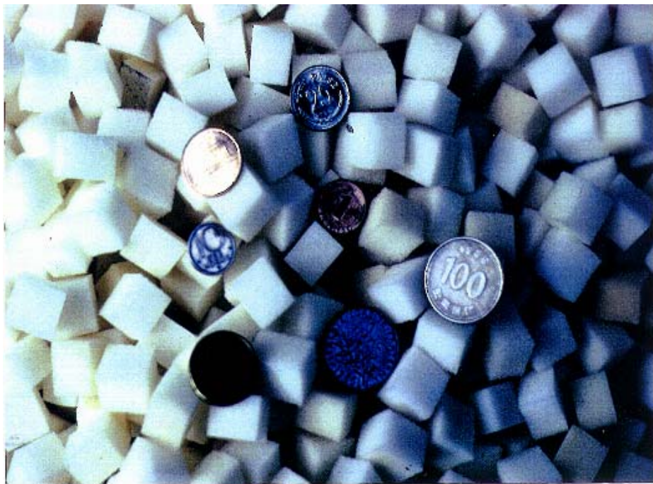
Linpor 工艺中应用的泡沫塑料方块生物膜载体
