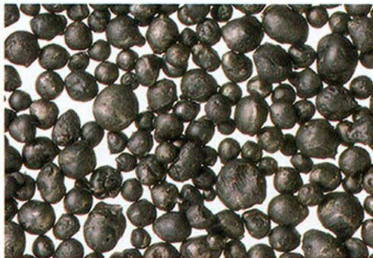
液态排渣冷却后生成的金属合金
